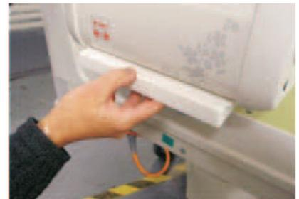
Abb. 11 Akku einsetzen
