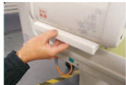
Abb. 12 Akku einsetzen
