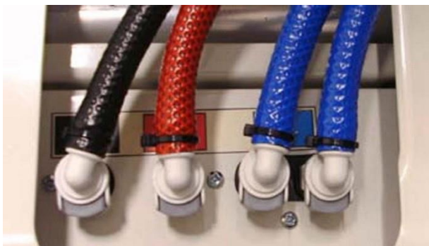
Fig. Farbcodierte Luftschläuche
