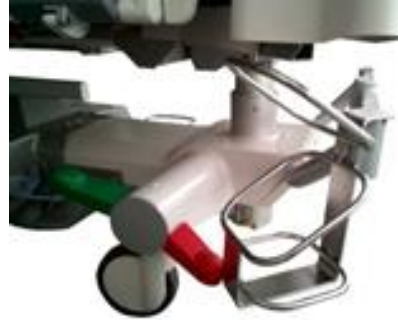
Fig. Sauerstoffflaschen-Halter B- falsche Anbringung
