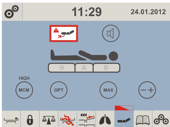
Fig. Warnung - gelöste Luftleitungen
