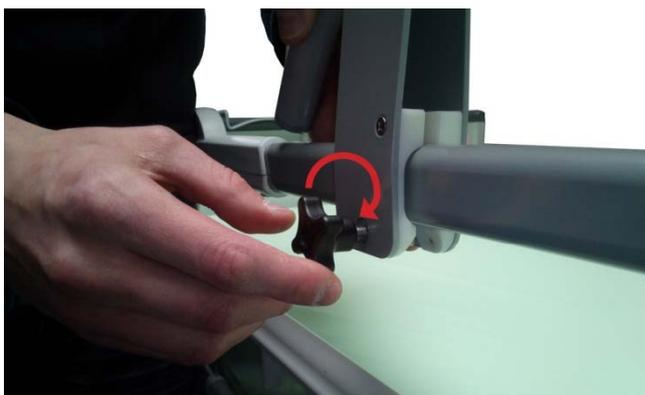
Fig. 20 Extender® sichern.
