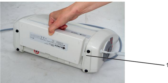
Abb.21 Einsetzen der Reservebatterie
