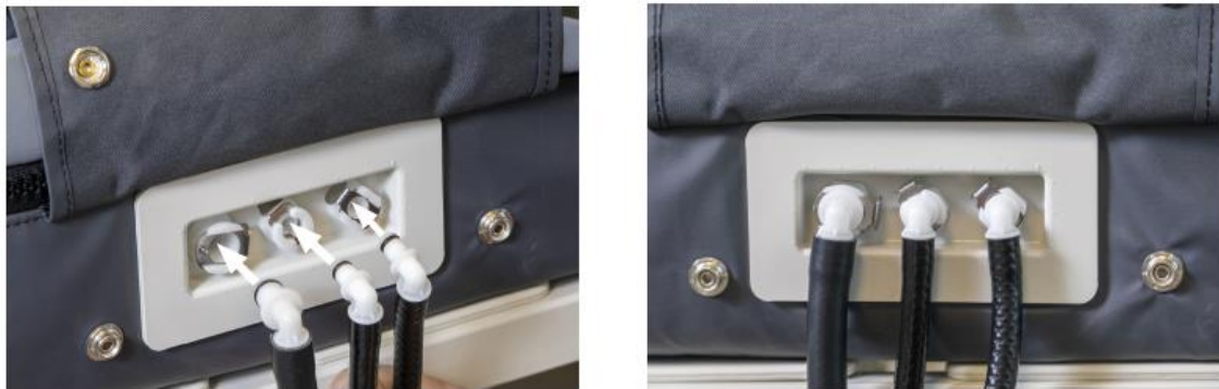
Abb. 7 Anschluss der Luftleitungen an die Matratze mit MCM-Modus
