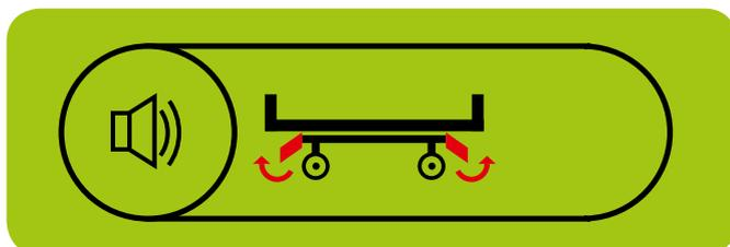
Der **Brems-Assistent** signalisiert, wenn nach einem Pflege- oder Reinigungsvorgang die Bremse gelöst und nicht wieder festgestellt wird.
