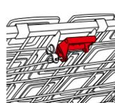
Sistema de accionamiento CPR en el respaldo
